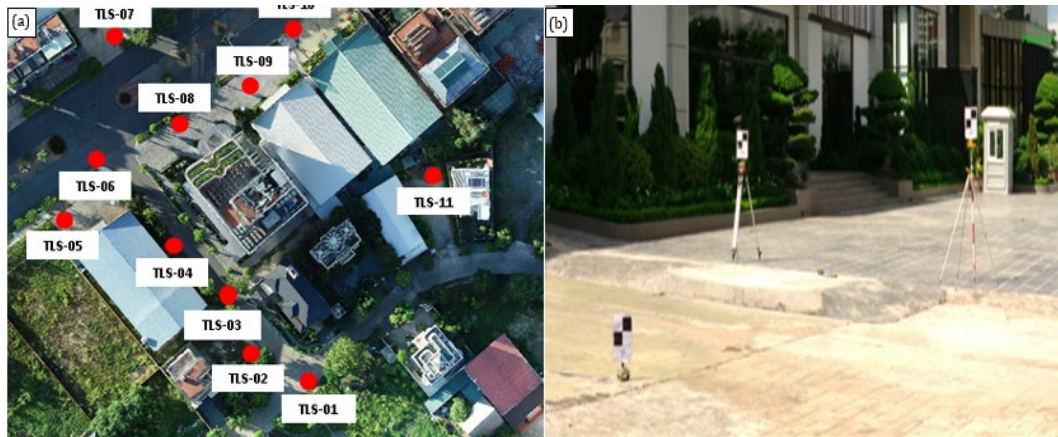
Hình 4. Sơ đồ bố trí các trạm quét laser 3D mặt đất xung quanh tòa nhà cao tầng (a); Tiêu TLS và cách bố trí các tiêu trên mặt đất (b).
