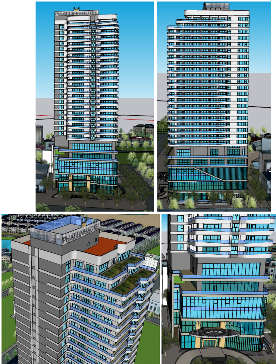
Hình 10. Mô hình 3D cấp độ chi tiết LoD3 của tòa nhà cao tầng khu vực TP. Hạ Long, tỉnh Quảng Ninh.
